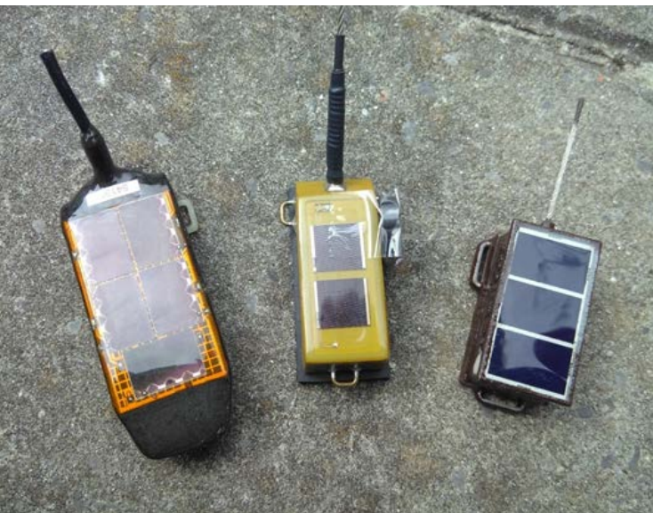
Een UvA-BiTS GPS-logger (links), Microwave satellietzender (midden) en een Milsar GPS/GSM-logger (rechts). © W GK
