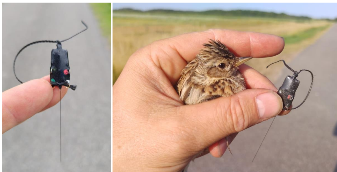
Figuur 2.1. De NanoFix logger van Pathtrack is klein genoeg om aan een zangvogel te bevestigen.
